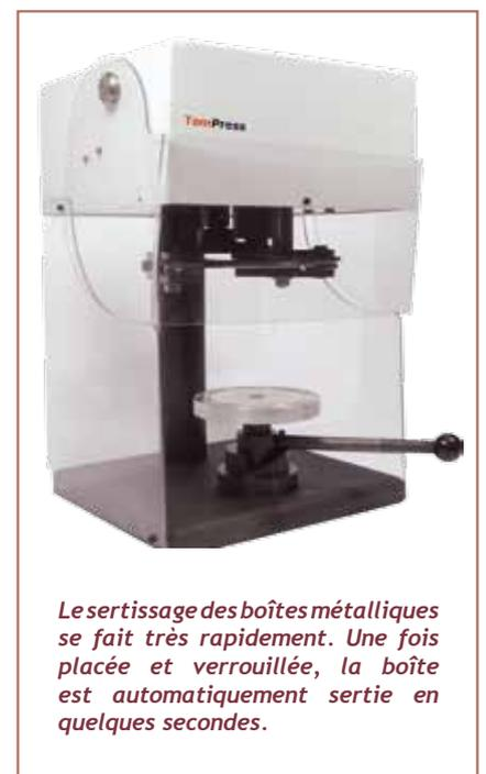
*Le sertissage des boîtes métalliques se fait très rapidement. Une fois placée et verrouillée, la boîte est automatiquement sertie en quelques secondes.*
