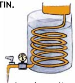
Le serpentín est un long tube enroulé sur lui-même. Immérgé dans l'eau bouillante, il réchauffe progressivement le jus qui s'y écoule. C'est en réglant le débit du jus dans le serpentín que l'on maîtrise très finement la température. Plus le jus reste longtemps dans le serpentín, plus il est chaud.
